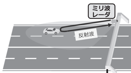
図3 ミリ波レーダによる車両検知の例
