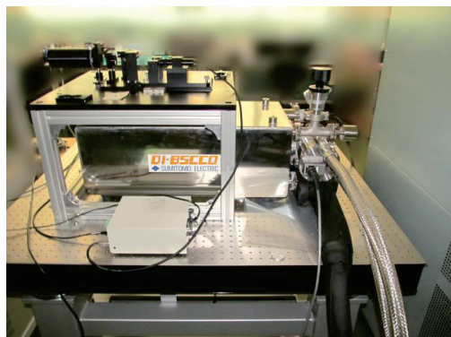
写真3 ハードディスク検査用マグネット (ネオアーク提供)
