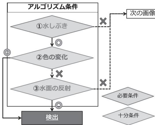
図12 監視システムを実際に動作させた時の条件分岐
