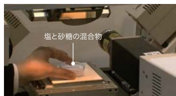
▲検査対象をカメラの下に置くだけ。前処理は何も必要ありません。
