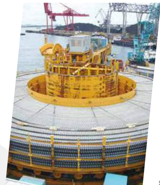
布設船に積み込まれた海底ケーブル
