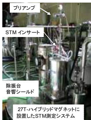
図 1: 超強磁場 STM 測定システム。
